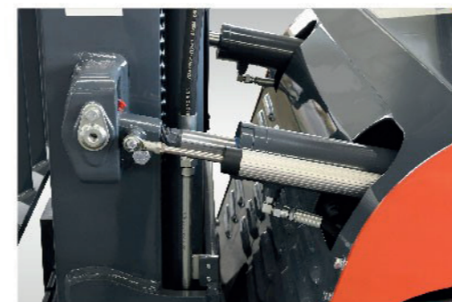
El sistema de control de seguridad inteligente opcional ajusta el ángulo de inclinación y la velocidad para mejorar la seguridad
