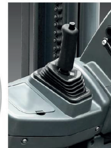
El nuevo tipo de freno de mano de trinquete reduce la fuerza de operación en un 17%.
