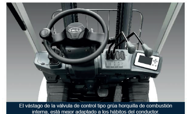
El nuevo tipo de freno de mano de trinquete reduce la fuerza de operación en un 17%.
