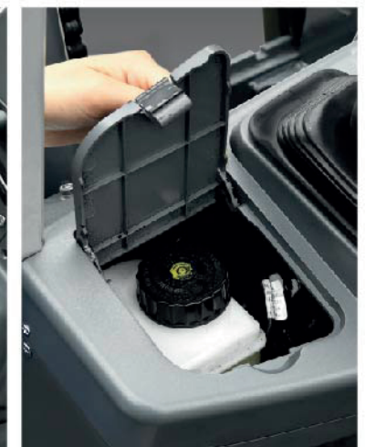
Líquido de frenos accesible, fácil de comprobar y rellenar
