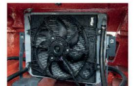
El sistema de disipación de calor y refrigeración líquida de alta eficiencia está equipado de serie, lo que puede cumplir con los requisitos del sistema de trabajo continuo S1 del automóvil;
