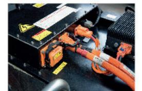
Protección de seguridad de voltaje a nivel del sistema: El camión presenta un diseño integrado/más corto de conexión de voltaje y protección de monitoreo de aislamiento múltiple; Diseño seccional de seguridad de voltaje de nivel del sistema: cuando se retira el interruptor de mantenimiento, el sistema falla o se desconecta la llave, el sistema de voltaje se desconectará automáticamente y el voltaje máximo no será superior a 76,8 V;
