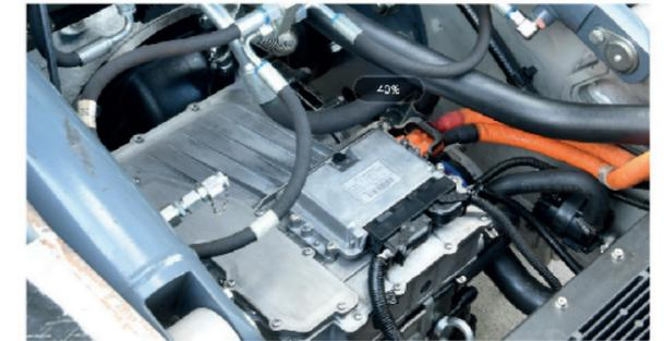
El sistema de energía integrado reduce el mazo de cables, lo que reduce en gran medida la pérdida de transmisión de energía eléctrica. Y los niveles de piezas y módulos de control son claros y convenientes para el mantenimiento;
