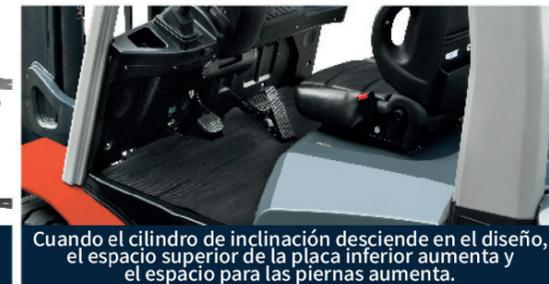
Cuando el cilindro de inclinación desciende en el diseño, el espacio superior de la placa inferior aumenta y el espacio para las piernas aumenta.
