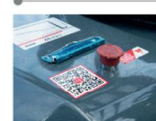
El interruptor de apagado de emergencia está equipado de serie para garantizar la seguridad en caso de emergencia;
