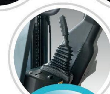
El freno de mano tipo trinquete realiza diferentes fuerzas de frenado en pendientes y terreno plano, lo que reduce la fatiga del operador;
