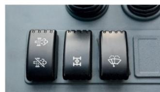
Equipado con función de cambio entre tracción en dos ruedas y tracción en las cuatro ruedas, se puede cambiar entre tracción en dos ruedas y tracción en las cuatro ruedas en cualquier momento. Es conveniente.
