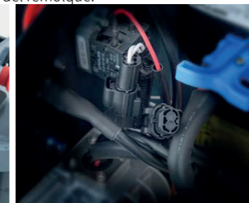
Dispositivo de desbloqueo del freno electromagnético de reserva
