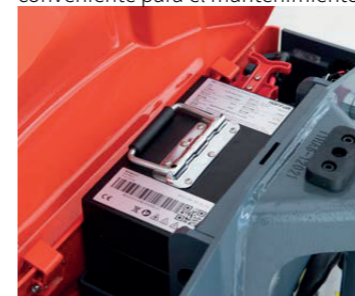
Batería de litio portátil
